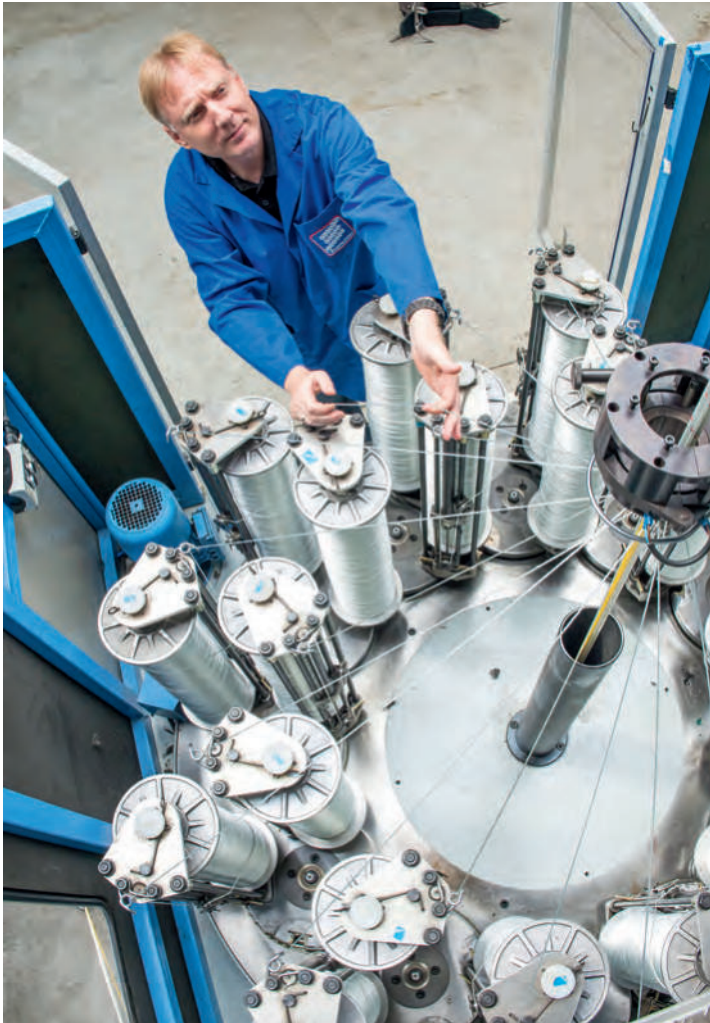
Endkontrolle der gespannten Flechtseile vor Fertigungsbeginn
