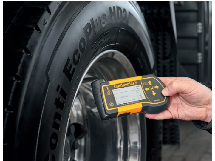
Mit dem ContiPressureCheck™-Handgerät wird der Luftdruck geprüft.
